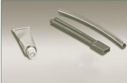
**KSR-CFK...**juego de creación de circuitos para usar en áreas peligrosas e industriales. Termina los cables calefactores SX en una caja de empalme JB-K-0-M25 (u otra). El juego incluye un conector de terminales eléctricos, una tapa para extremos, adhesivo RTV y un manguito de cable de puesta a tierra amarillo/verde.
