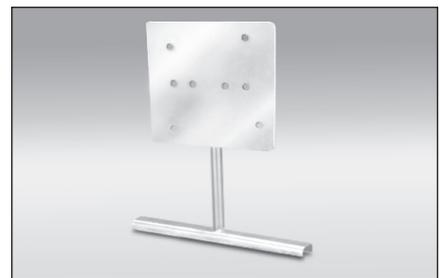
**XP-1...**soporte de montaje taladrado previamente de acero inoxidable (tipo 304) para instalar las cajas de empalme y los termostatos Thermon® directamente a los sistemas de tuberías. El soporte se sujeta fácilmente a la tubería usando las bandas de sujeción B4, B-10 o B-21. El XP-1 utiliza una distancia de 110 mm.
