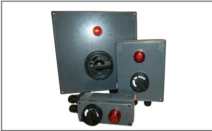
**CS-L\*-Ex....** el interruptor de circuito con lámpara se usa como interruptor de aislamiento en línea para circuitos de traceado calefactor monofásico, fase a fase y trifásicos. Disponible en versión de 16 A, 25 A y 40 A.
