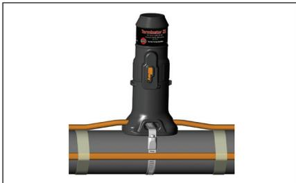
**Terminator™ ZS/ZE...** está diseñado para crear empalmes por fuera del aislamiento o terminaciones del circuito de los cables calefactores de Thermon®. Las conexiones eléctricas se hacen con sujetadores de cable (para aplicaciones que requieren terminaciones con conexiones de bloque de terminales, se puede usar el juego Terminator™ ZP).
